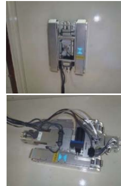
S/C水位測定 調査ロボット
