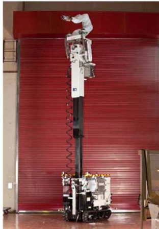
高所調査用ロボット
